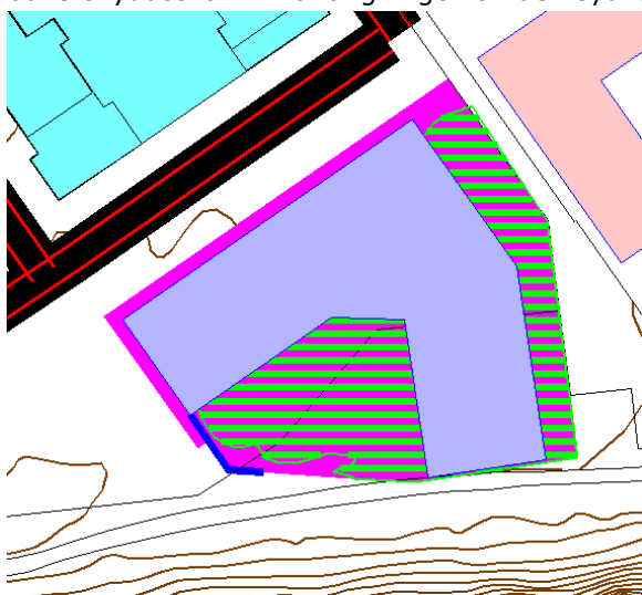
Figur 6: Tillgänglig uteplats markerad i lila. Område som uppfyller både Leq < 50 dBA och L_{max} < 70 dBA markerat i grönt, skärm 4m markerad i blått.
