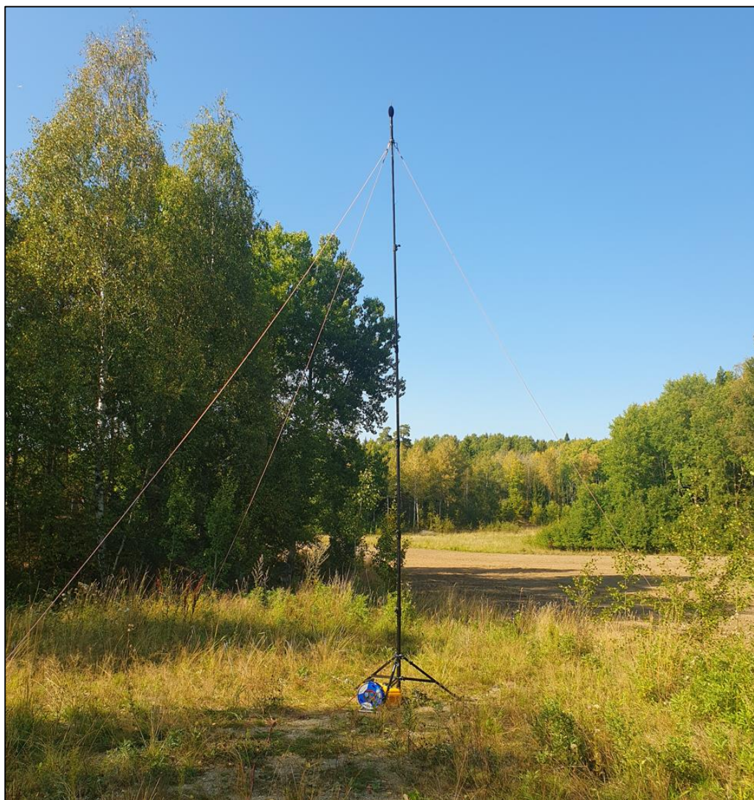
Figur 2. Bild på mätuppställningen i Edsby i Upplands Väsby kommun, bestående av stativ, mikrofon och övrig utrustning som hör till mätningen.
