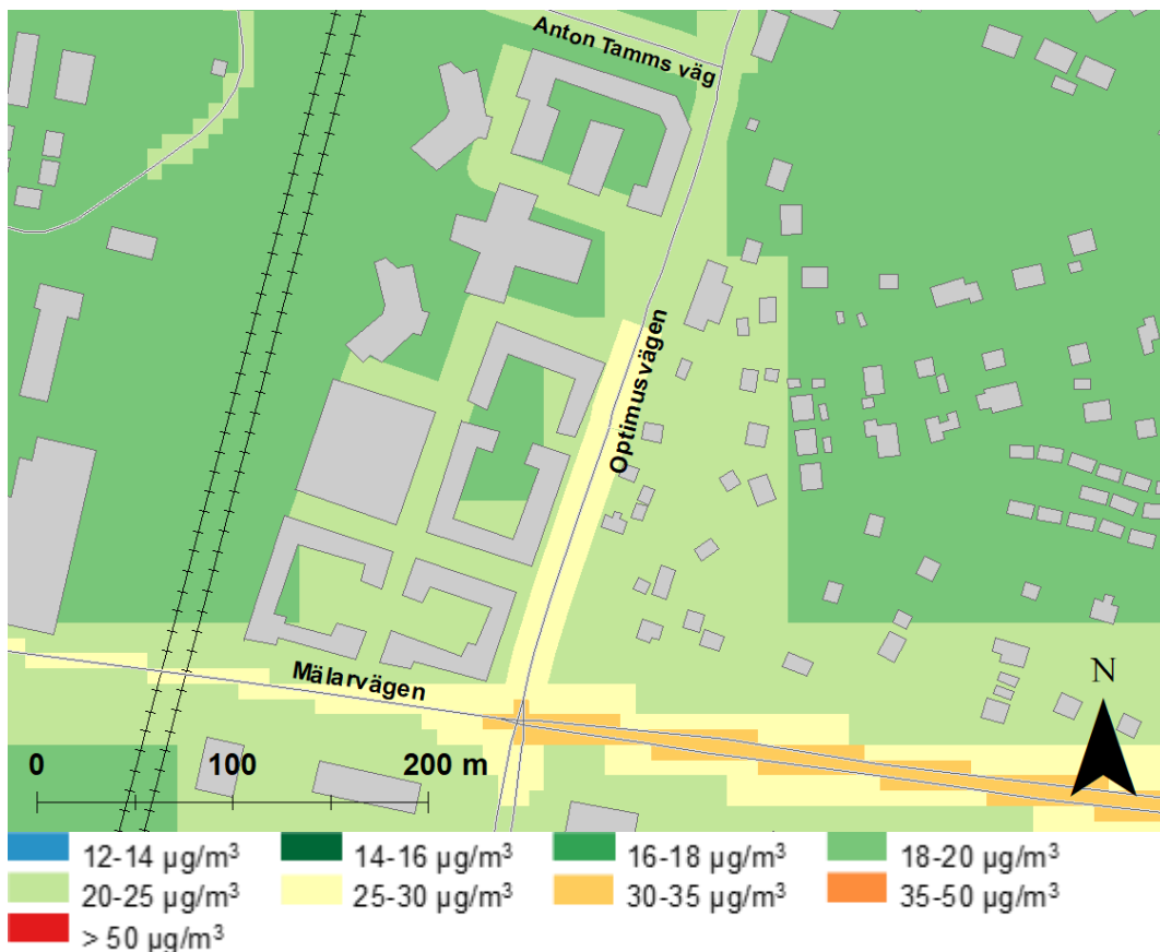
Figur 7. Beräknad dygnsmedelhalt av partiklar, PM10 ( \mu\text{g}/\text{m}^3 ) under det 36:e värsta dygnet för utbyggnadsalternativet år 2020 med 0% trafikökning Normvärdet samt målvärdet som ska klaras är 50 \mu\text{g}/\text{m}^3 respektive 30 \mu\text{g}/\text{m}^3 .
