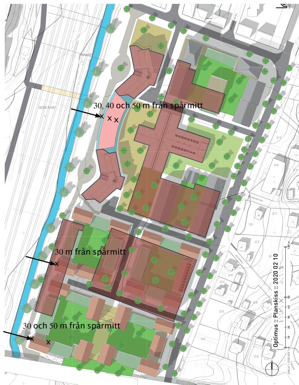
Figur 1.1 De planerade husen i projekt Optimus ligger som närmast ca 30 m från spårmitt på närmsta spår
